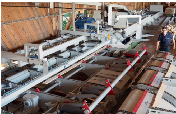
Manipulationstisch vor dem Besäumer: Schwarten lassen sich über eine Klappe ausschleusen, dann geht es zur Vermessung und zum Einzug
