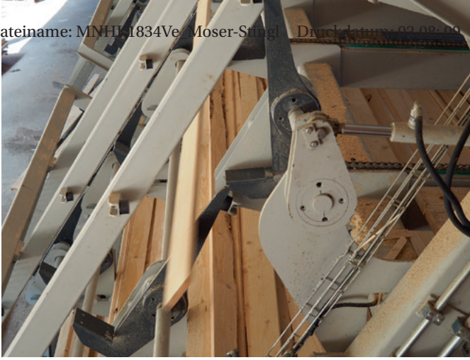
Die Zuteilung in die Etagen erfolgt stirnseitig über Klappen – so rutscht das Holz immer Stück für Stück tiefer
