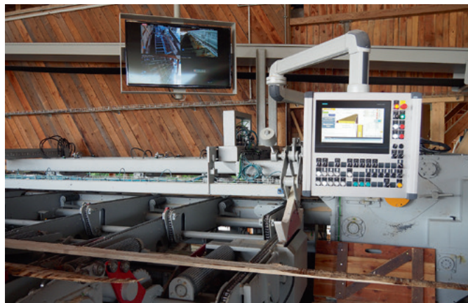
Schwartenanläufe lassen sich noch ausklappen; auch die Steuerung (rechter Bildschirm) stammt von der Maschinenfabrik Stingl
