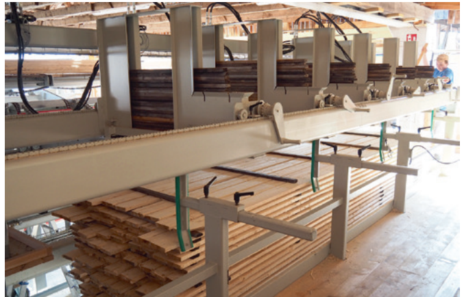
Die Paketierung ist mit einer automatischen Lattenlegung mit sechs Magazinen ausgestattet
